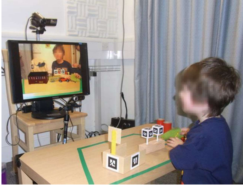
صورة 3. نظام الواقع المعزز المصمم من قبل زين باي لمساعدة الأطفال في اللعب التخيلي. مجموعة رسومات الصور والتفاعل / مختبر الكمبيوتر بجامعة كامبريدج
